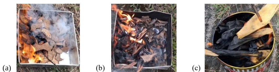
Gambar 1. (a) Tempurung kelapa dalam proses karbonisasi, (b) kulit singkong dalam proses karbonisasi, (c) kulit jagung dalam proses karbonisasi
