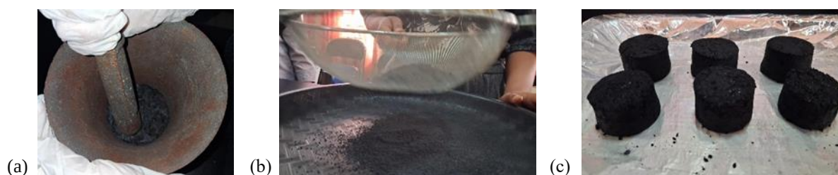
Gambar 2. (a) Proses pengayakan arang, (b) pencampuran bahan baku dan bahan perekat, (c) hasil briket yang sudah dicetak
