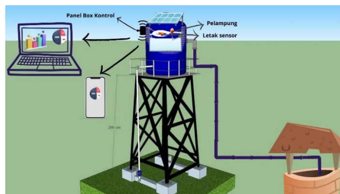
Gambar 3. Desain Sistem Monitoring pada Tandon Air
