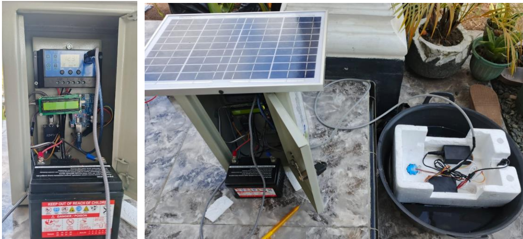
Gambar 10. Sistem Monitoring pada Tandon Air
