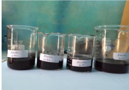
Gambar 1. Sampel tinta dengan variasi pelarut akuades
